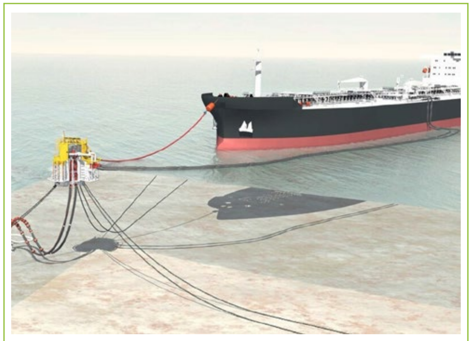
Conexión de buque tanque con monoboja tipo torreta Fuente: Plan Maestro Portuario del Litoral Pacífico.
